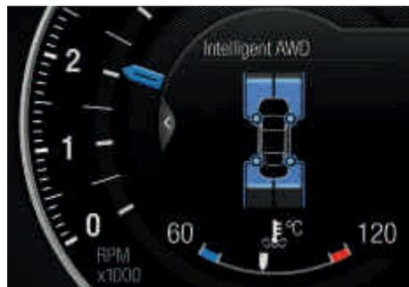
Una pantalla especial en el cuadro de instrumentos muestra la distribución de la potencia en las cuatro ruedas. (De serie en los motores con tracción 4x4)
